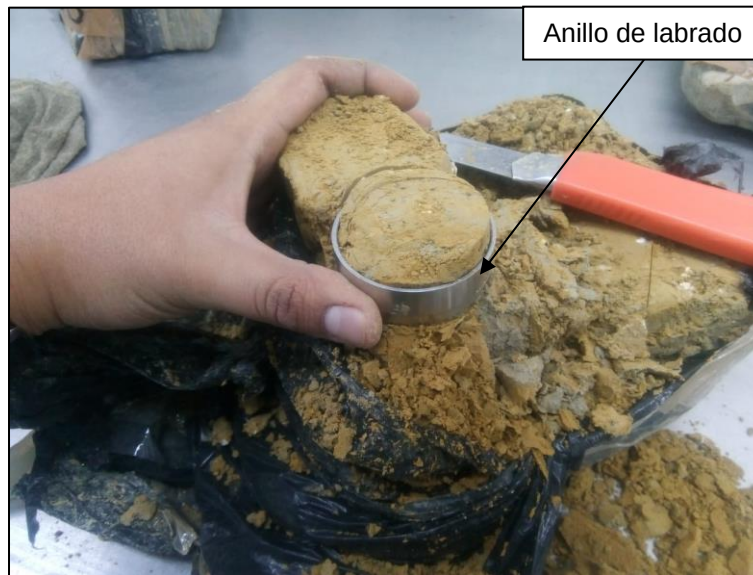
Figura 3.1. Labrado de probetas para la prueba de corte directo con ayuda de un anillo de labrado
