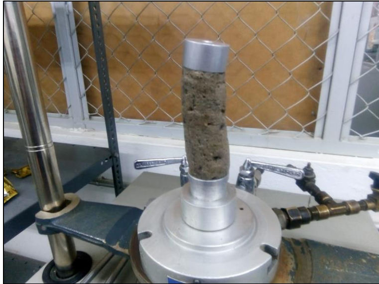
Figura 3.18. Probeta al final del ensaye de compresión triaxial
