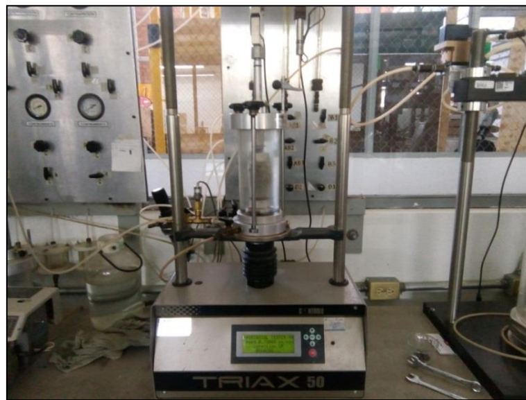
Fig. 1.6. Cámara de compresión triaxial del Laboratorio Integral de la FI-BUAP
