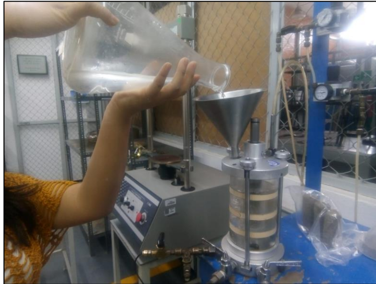
Figura 3.16. Llenado de la cámara triaxial con agua destilada
