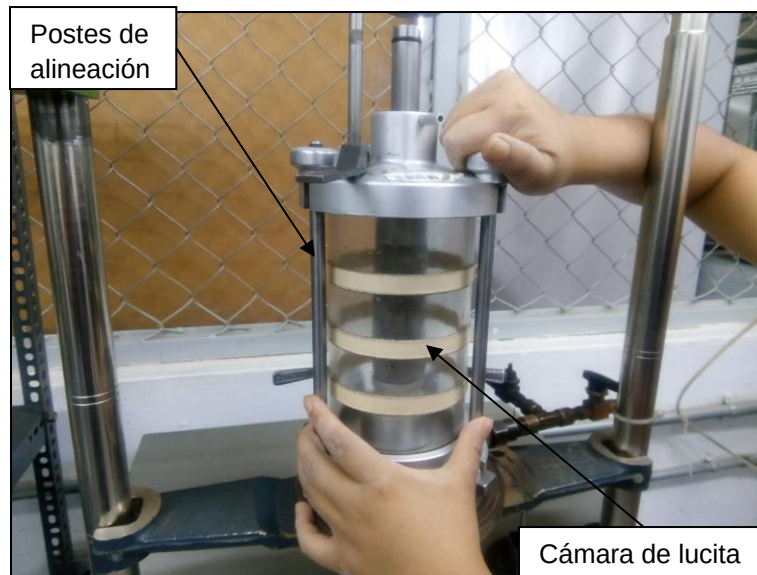
Figura 3.15. Ensamble de la cámara triaxial
