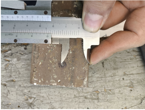
Figura 3.38: Ancho de cara de donde se saca la medida para la cara contraria.
