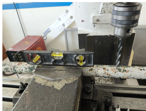
Figura 3.28: Barrenado de tubular.
