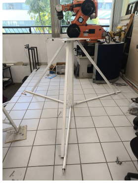
Figura 3.50: Ensamble de tubulares laterales con inferiores internos.
