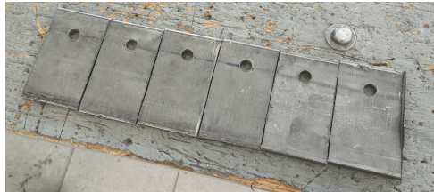
Figura 3.19: Solera tipo aleta para barras laterales.
