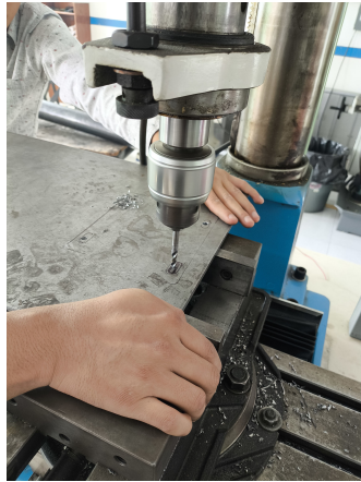
Figura 3.59: Barrenado en la placa.
