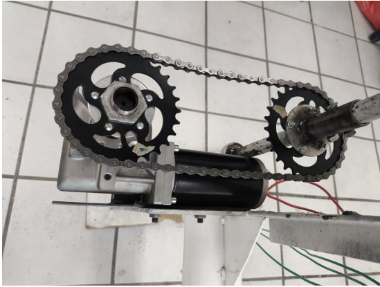
Figura 4.12: Motor reductor ensamblado al mecanismo.
