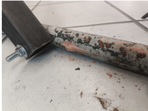
Figura 3.29: Tubular unido al PTR con tornillo.
