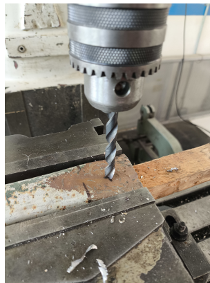
Figura 3.20: Barrenado en tubular.
