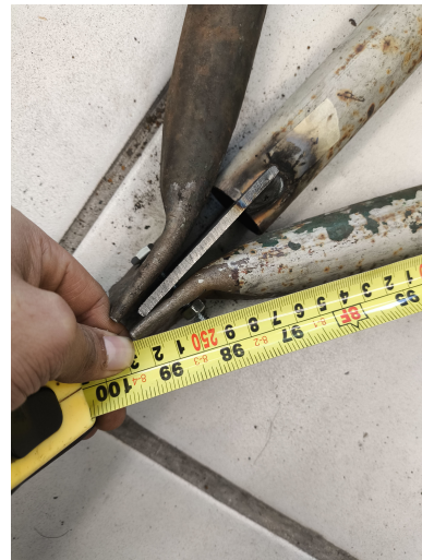
Figura 3.41: Comprobación de la distancia de los tubulares externos.
