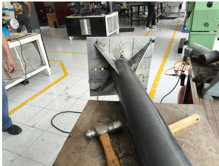
Figura 3.55: Placa unida al tubular con soldadura.
