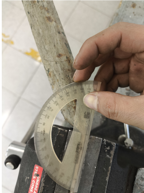
Figura 3.36: Tubular con dobles a 150 grados.
