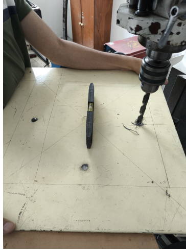
Figura 3.44: Barrenado de la placa.
