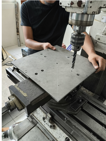
Figura 3.54: Barrenos en la placa.
