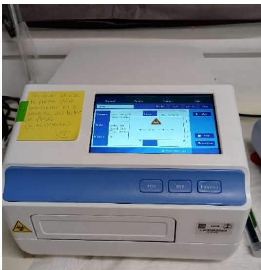
Figura 9. Lectura de absorbancia de la actividad de fenoloxidasa en el lector de placas.
