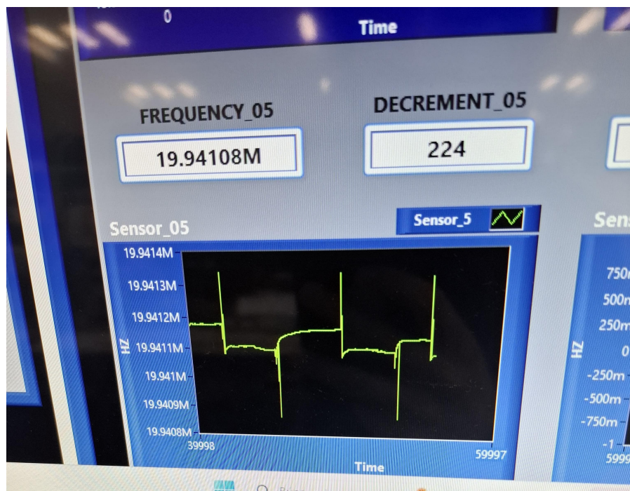
Figura 3.29: Visualización del gráfico de la respuesta de un sensor de tipo QCM en la interfaz desarrollada en el laboratorio.
