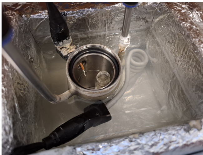
Figura 3.25: Cámara de evaporación de COV en baño térmico.
