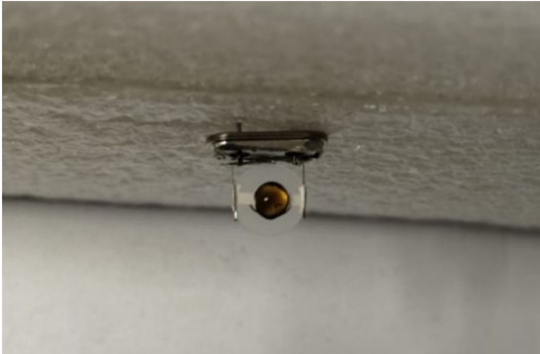
Figura 3.18: Gota de la solución depositada en el centro del electrodo del cristal.
