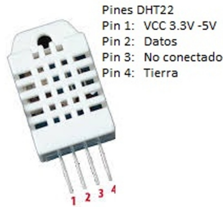
Figura 3.22: Sensor de humedad DHT22 [42].
