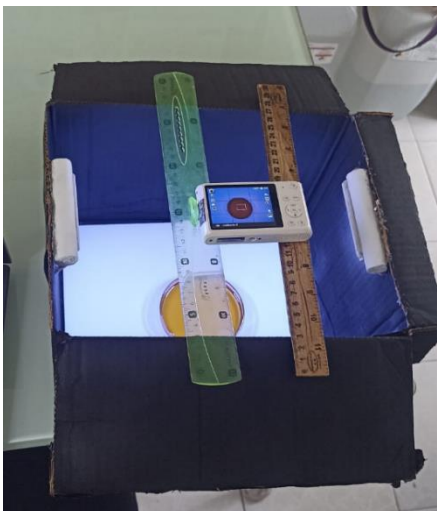
Ilustración 9: Vista superior de la caja diseñada para la obtención del color de la miel. Fuente: Propia.
