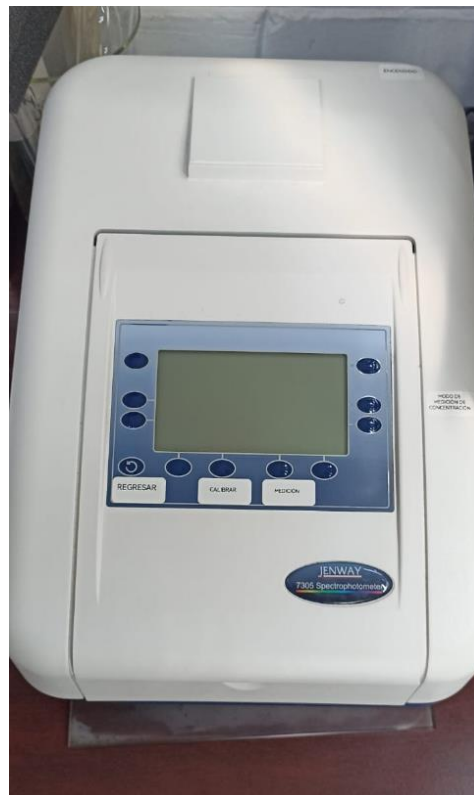
Ilustración 12: Espectrofotómetro UV-Vis de la marca JENWAY. Fuente: Propia.
