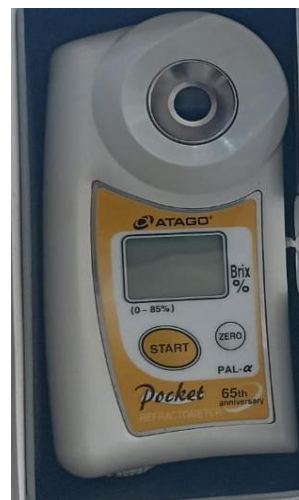
Ilustración 7: Brixómetro de la marca ATAGO. Fuente: Propia.
