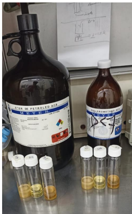
Ilustración 17: Muestras de miel en contacto con los solventes (dicloro metano y éter de petróleo).
