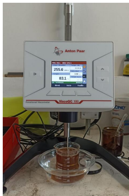
Ilustración 8: Viscosímetro de la marca Anton Paar. Fuente: Propia.
