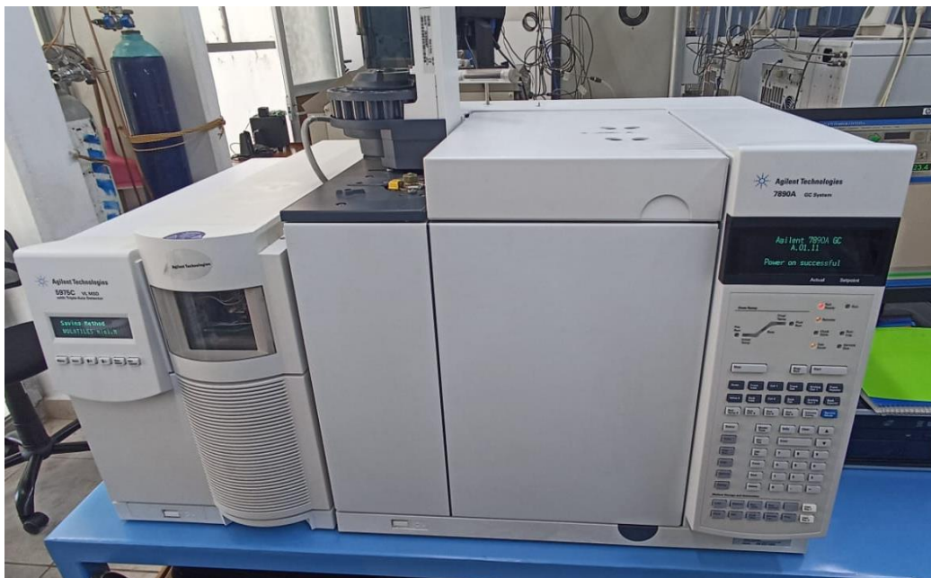
Ilustración 14: Cromatógrafo de gases acoplado al espectrómetro de masas ambos de la marca Agilent Technologies. Fuente: Propia.
