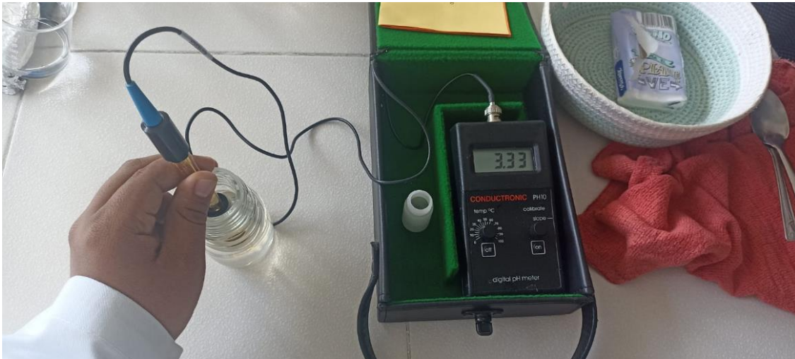
Ilustración 10: Potenciómetro de la marca CONDUTRONIC. Fuente: Propia.
