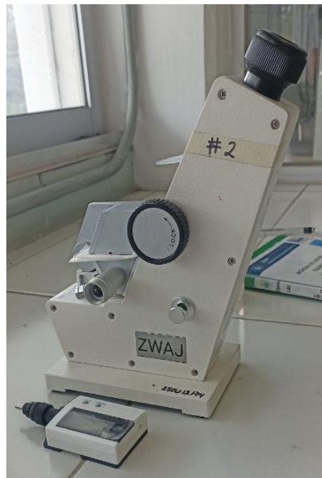
Ilustración 11: Refractómetro ABBE de la marca CIVEQ con termómetro. Fuente: Probia.
