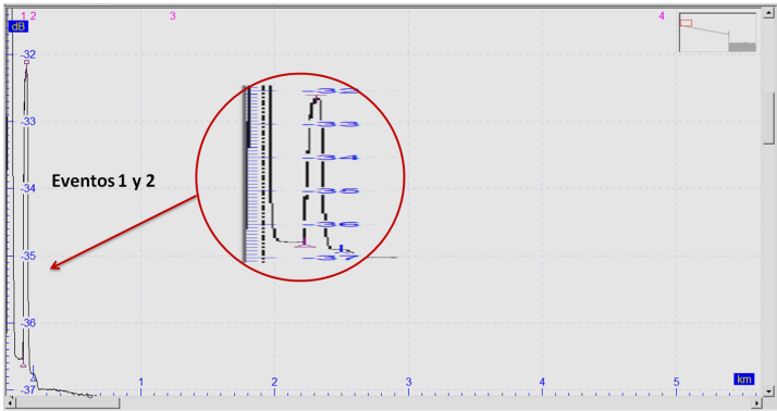
Figura 5.17: Gráfica de OTDR que representa inicio de fibra óptica y un conector.
