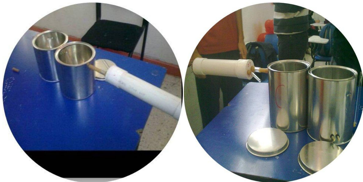
Fig. 15. Ensamblado completo del equipo de destilación por arrastre de vapor.
