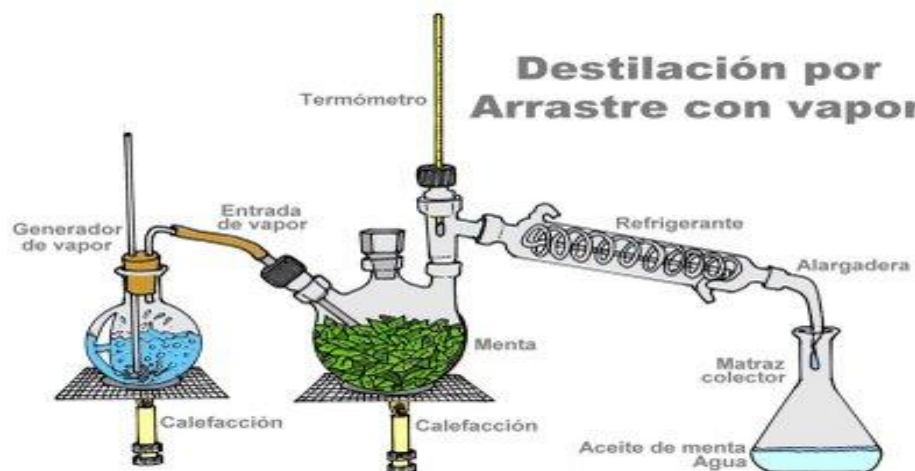
Fig. 7. Destilación por arrastre con vapor.
