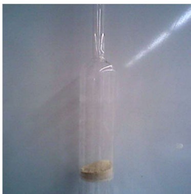
Figura 4. Reactor de cuarzo conteniendo cada nanocatalizador
