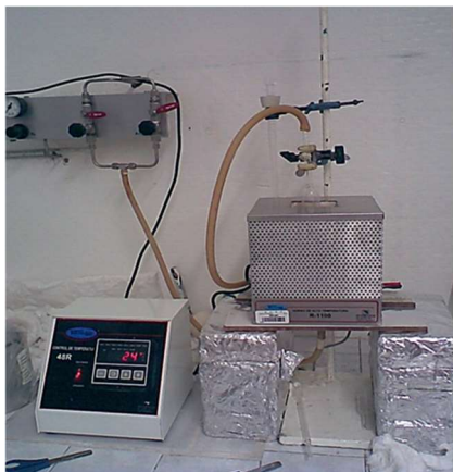
Figura 5: Calcinación con el Horno de Alta Temperatura, flujo de aire y controlador
