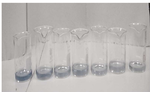
Figura 12: Muestras del proceso de fotodegradación catalítica respecto al tiempo
