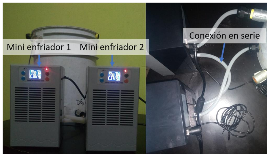
Figura 7.14: Conexión de los mini-enfriadores.
