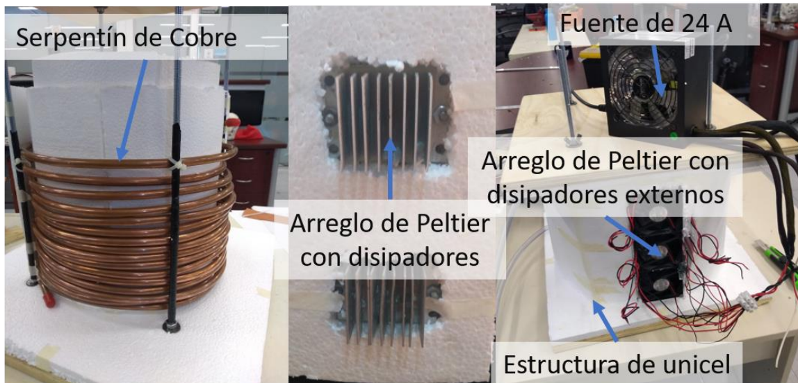
Figura 7.10: Estructura disipadora con arreglo de celdas Peltier.
