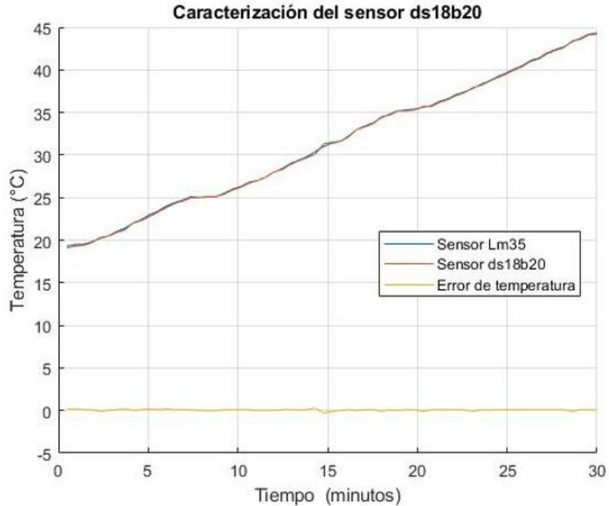
Figura 4.5: Caracterización del sensor ds18b20 utilizando un Lm35.
