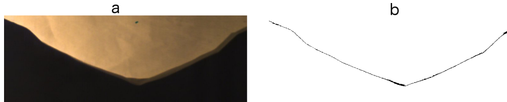
Figura 3.20: a) Cráter resultante del colapso de una cavidad en un sistema 2D. b) Digitalización del cráter usando ImageJ.
