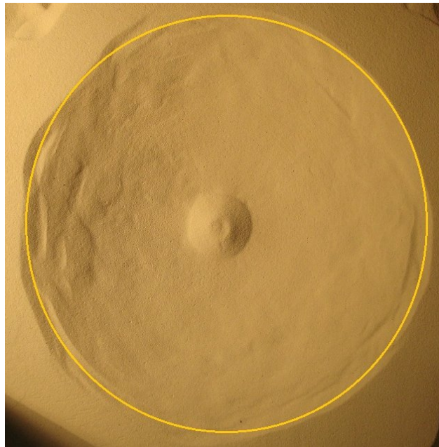
Figura 3.3: La técnica de ángulo bajo resalta las características del cráter, para posteriormente medirlas en ImageJ. El diámetro del cráter es obtenido mediante un ajuste circular (curva amarilla).
