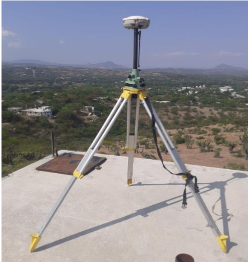
Imagen 20.- Receptor ComnavT300 estacionado, nivelado y armado en modo base.
