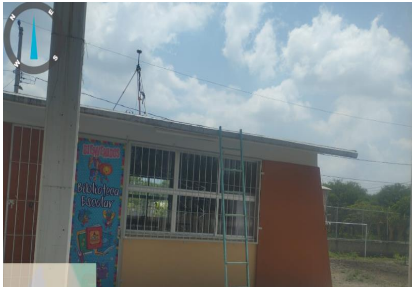
Imagen 23.- Antena receptora base ComNav T300 colocada en lo alto, centrada y nivelada para iniciar levantamiento topográfico.
