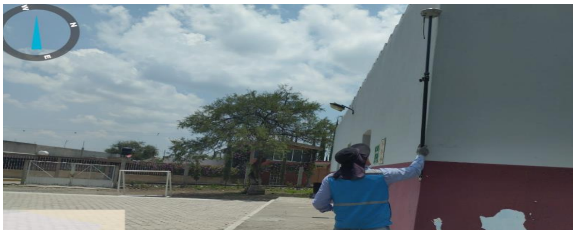
Imagen 45. Usuario y antena receptora en modo rover delimitando la superficie construida de predio en este caso lamina de un nivel.
