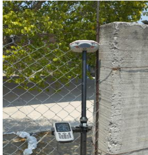
Imagen 21.- receptor ComnavT300 armado en modo móvil con controladora.
