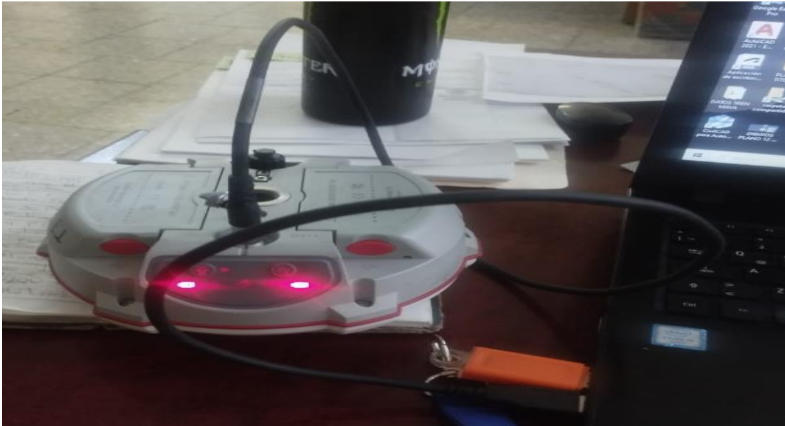
Imagen 67. Ejemplo de descarga de datos crudos de observación mediante base receptora base.
