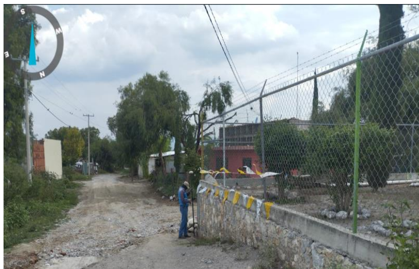
Imagen 43. Usuario y antena receptora en modo rover en lindero para delimitar al predio en cuestión.
