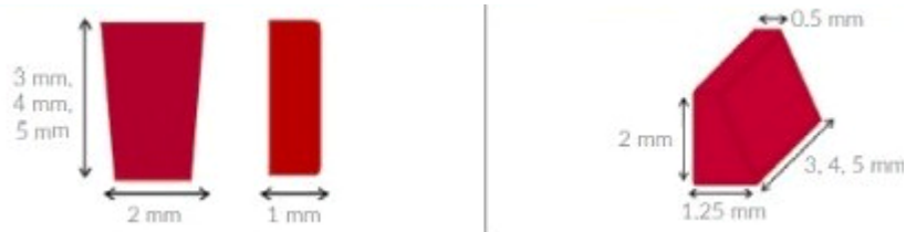
Figura 2. Aditamento rectangular vertical y aditamento biselado vertical.
