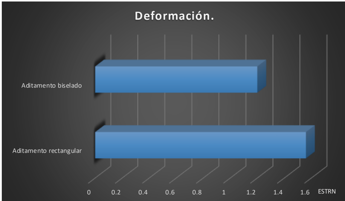
Figura 12. Comparación de los resultados máximos de deformación con aditamento biselado y con aditamento rectangular durante la simulación con FEA (Solid Works).
