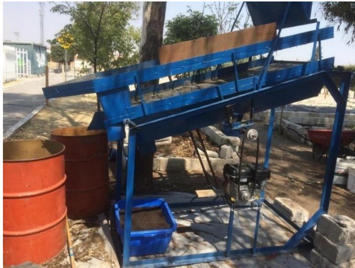
Figura 4. Cernidora utilizada para la obtención de la lombricomposta en dos granulometrías, a 2 y 5 mm, localizada en VermiBUAP.
