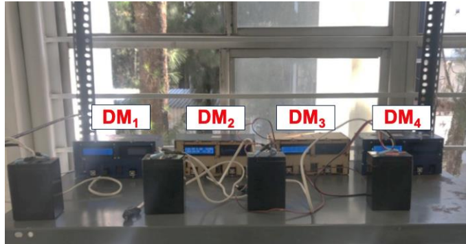
Figura 13. Mediciones simultáneas de PM 2.5 empleando los DM colocados en un ambiente estable dentro del edificio FCQ5 de la BUAP.
