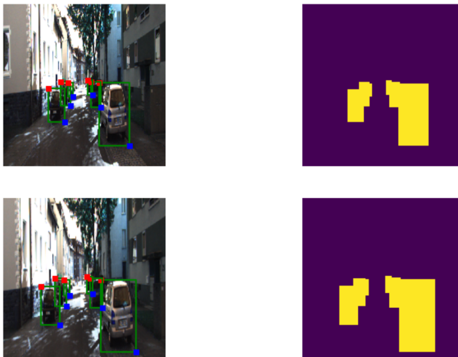
Figura 3.20: La red neuronal convolucional profunda U-Net necesita la imagen real con su correspondiente imagen con las máscaras de los objetos a predecir su segmentación y detección.
