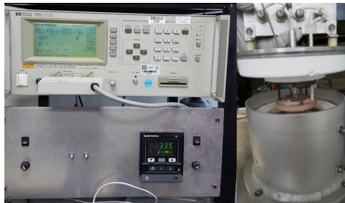
Figura 18 Instrumentación para mediciones dieléctricas con equipo LCR Precision - CNYN UNAM
