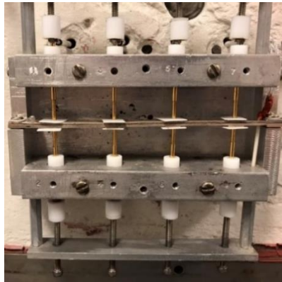
Figura 19 Celda de medición de las propiedades dieléctricas a baja temperatura.- Departamento de Ingeniería nuclear y mecánica de la Universidad de Estatal de Pensilvania, EUA.
