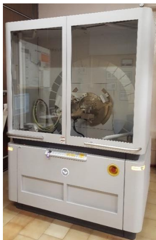
Figura 11 Difractómetro PANalytical, modelo Empyrean- Laboratorio de difracción de rayos X, IFUAP.
