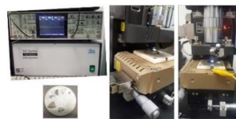
Microscopio de fuerza atómica Park Systems XE7 en el modo piezo-resonante con un amplificador DSP Lock-In de 4MHz
