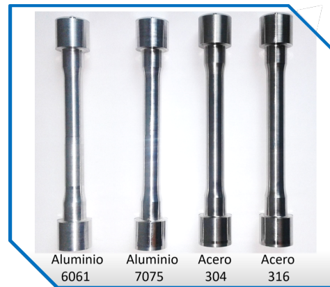
Figura 3.3: Probetas con cada aleación de metal siguiendo las normas DIN50125.
