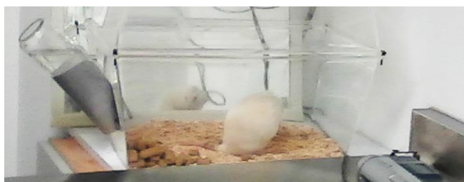
Figura 13. Rata colocada en la caja de registro. La rata se conecta al equipo de registro a través de un cable ligero conectado a un sistema giratorio tipo “swivel”, para que la rata pueda moverse libremente por la caja e incluso dormir en posición de ovillo.
