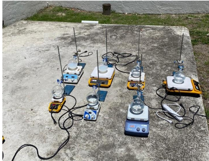
Figura 5. Muestras de levofloxacino para fotocatalisis expuestas a radiación solar en parrillas de agitación. Fuente: Elaboración propia
