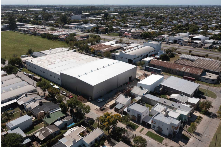
Figura 3.1.5- Ejemplo de rugosidad de superficie de categoría "B". Estructuras en zonas urbanas y suburbanas
