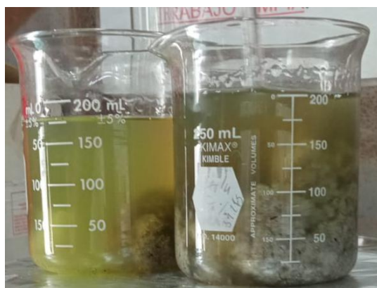
Ilustración 33. Gasolina con perla sucia de EPS en calentamiento y agitación constante.
