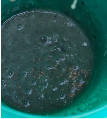
Ilustración 35. Mezcla homogénea de EPS y Gasolina.
