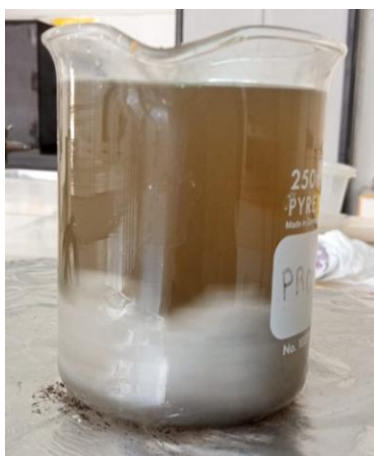
Ilustración 34. D-limoneno y perla sucia de EPS con calentamiento y agitación constante.
