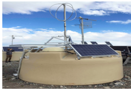
Figura 2.6: Detector de superficie actualizado, posee un detector de centelleo y una antena de radio en la parte superior [57].
