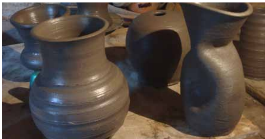
EJEMPLO 4.14 PRESIÓN EN PUNTOS PARALELOS En el lado derecho de la foto se observa una pieza recién hecha en el torno a la que se le aplicó presión. El resultado es una deformación en donde se ejerció la presión, cambiando la forma irreversiblemente.
