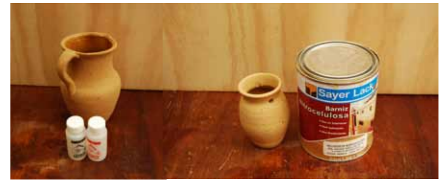
EJEMPLO 4.29 ALTERNATIVA DE RECUBRIMIENTO IMPERMEABLE La combinación de un sellador y una resina, le da mayor resistencia interna al objeto, cumpliendo la función de impermeabilizar la parte interna de la pieza, controlando la calidad del proceso.
