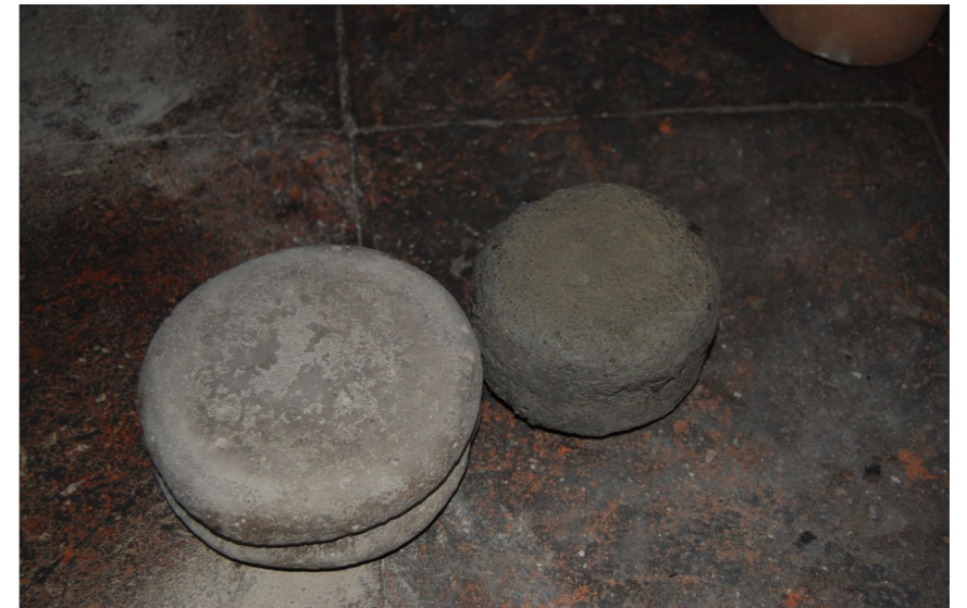
PIEDRAS DE RÍO UTILIZADAS COMO HERRAMIENTA Al trabajar el barro con la técnica de manero estas he- rramientas rudimentarias resultan indispensables para conseguir un grosor ideal en las piezas. Se aprovechan las caras planas y relativa- mente lisas de la piedra para aplanar y alisar el barro.
