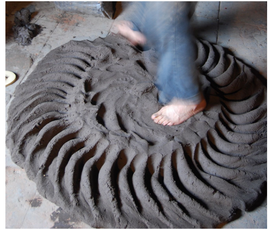
EJEMPLO I.6 MAESTRO JORGE LÓPEZ CANO AMASANDO EL BARRO El proceso para preparar el barro es agotador, requiere gran esfuerzo físico, se uti- lizan los pies porque se con- sigue más fuerza que con las manos y el resultado es uniforme, aunque es común lastimarse con las impurezas.
