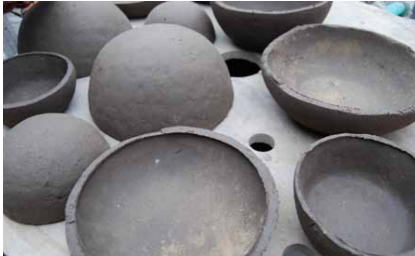
EJEMPLO 4.20 MANERO CON MOLDE La técnica de manero es utilizada para la creación de piezas en las que se utiliza un molde como base, la cual crea la forma de la pieza. Una vez creada, se corta el borde con ayuda de la flecha.
