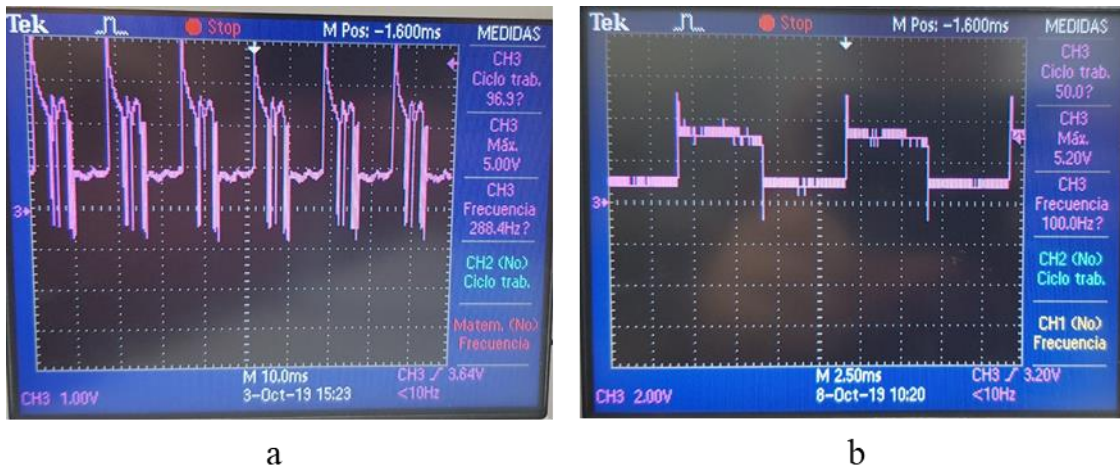
Figura 50. Arreglo de señal para motor a pasos: a) Señal sin diodos, b) Señal con diodos.
