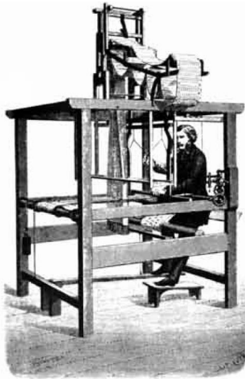
Figura 3. Máquina textil de Joseph Jacquard programada mediante tarjetas perforadas.
