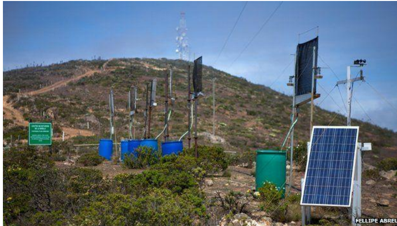
Figura 31. Sistema de captación de agua (atrapanieblas) en la zona de Antofagasta. Recuperado de BBC MUNDO (2015).
