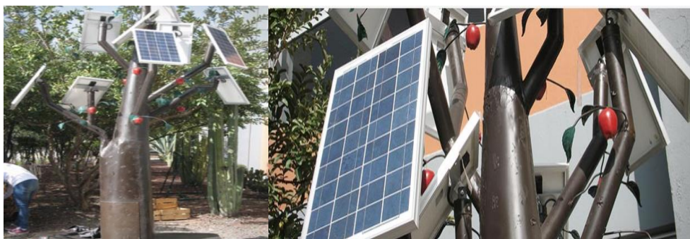
Figura 29. MeHai Tree, prototipo de árbol artificial para generar energía eléctrica a través de la utilización de sistema fotovoltaico. Recuperado de: CONACYT, Agencia Informativa, (2015).
