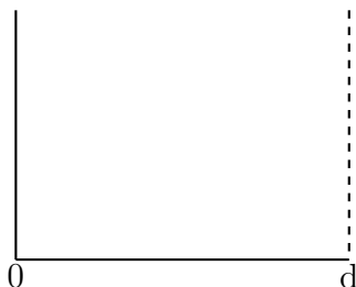
Figura 3.1: Sistema caja vacía de ancho d que cumple condiciones de frontera de Dirichlet en x = 0 y de Robin en x = d . Note que el fondo del potencial está en E = 0 .
