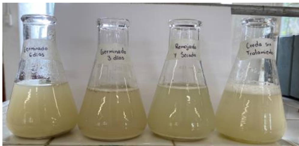
Figura 4. Prueba de espuma para determinar la presencia de saponinas en lenteja.
