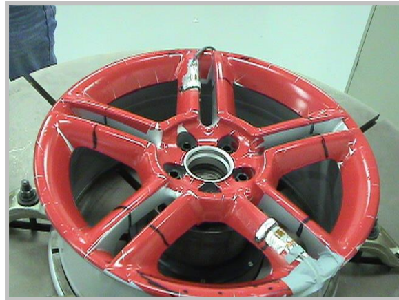
Instrumentación del rin para medición de esfuerzos, listo para someterse a fatiga.
