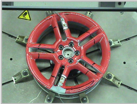
Instrumentación del rin para medición de esfuerzos, listo para someterse a fatiga.
