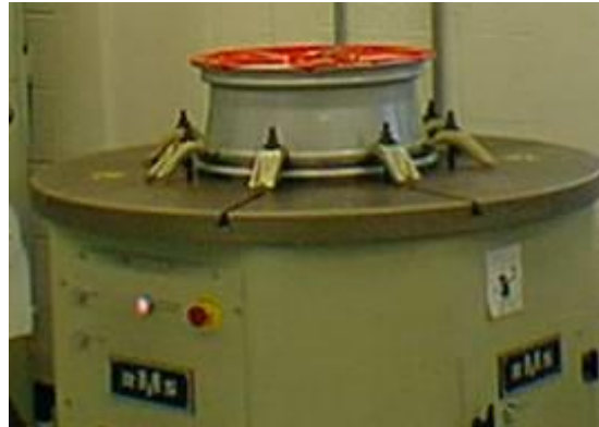
Fijación real del rin en la base del arillo.
