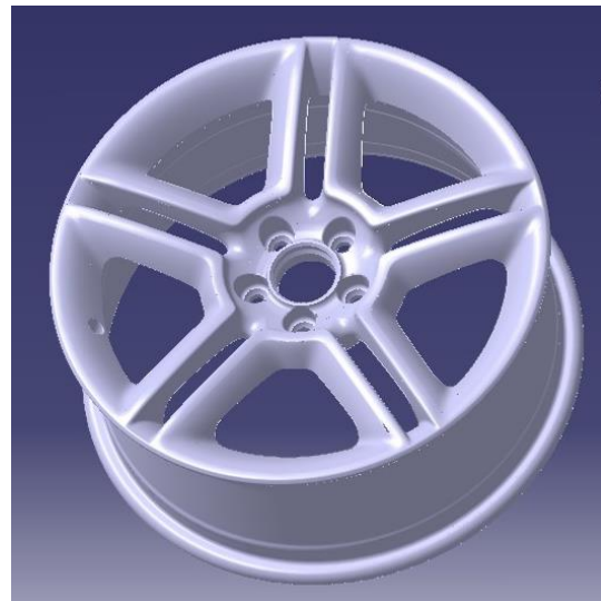
Modelo en CAD de rin a analizar
