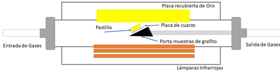
Figura 55: Arreglo experimental para el proceso de sinterizado de pastillas/blancos en el horno MOCVD.
