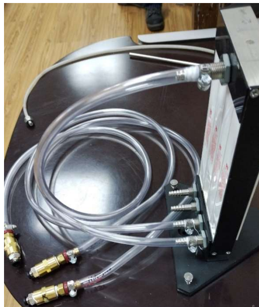
Figura 62: Flujómetro múltiple utilizado para controlar y mezclar los gases de N_2 y Ar.
