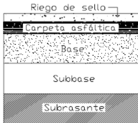
Figura 4.1.13.- Características de un pavimento flexible
