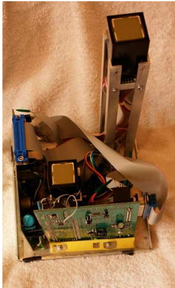
Figura 5.22: La cámara oscura, ensamble completo del sistema, se puede apreciar la posición de cada fotodetector correspondiente a cada telescopio.
