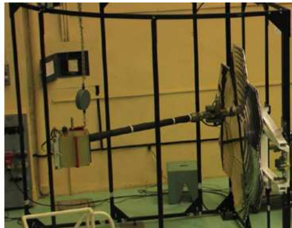
Figura 4.2: Espejo concentrador y el detector de radiación UV, realización de pruebas de laboratorio en las instalaciones de la Universidad Estatal de Moscú.
