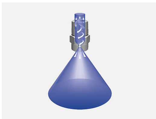
Figura 2.5: Huella de aspersión de boquilla de cono lleno
