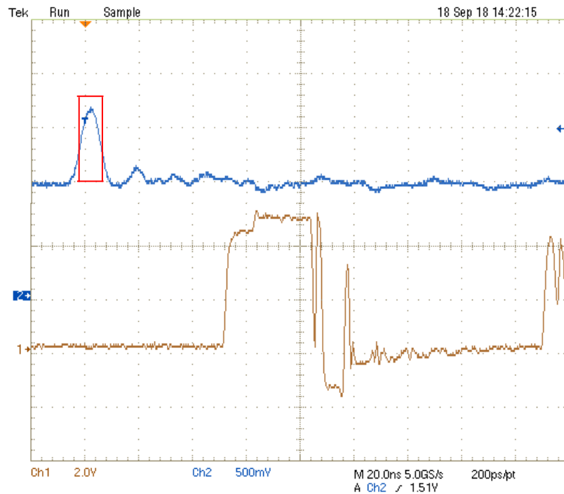
Figura 4.22: Respuesta del APD a un ancho de pulso de 8ns.
