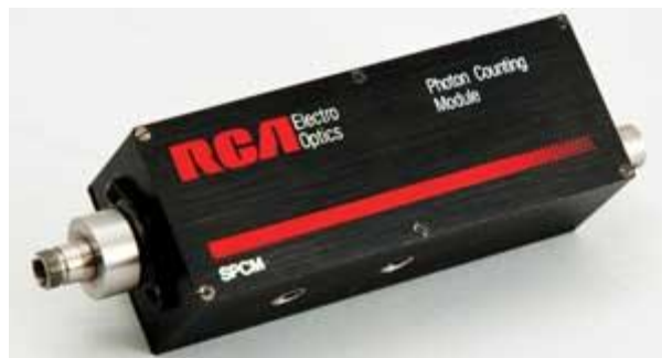
Figura 0.4: Detector comercial desarrollado por la compañía canadiense RCA.
