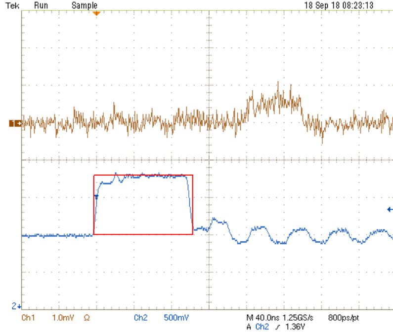
Figura 4.5: Respuesta del detector a un ancho de pulso de 100ns.
