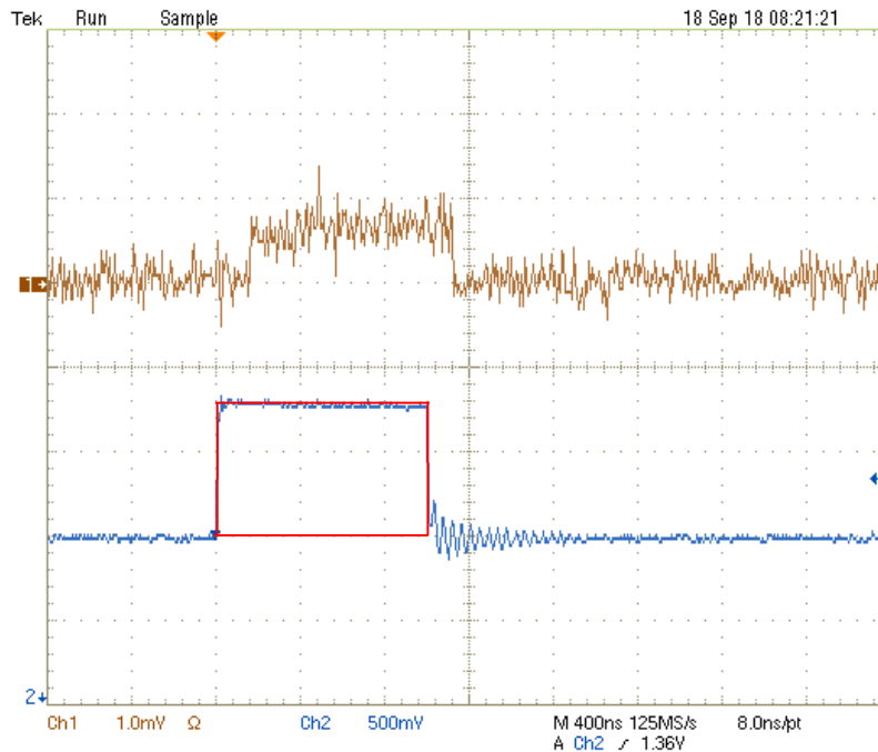
Figura 4.4: Pulso generado vs respuesta del fotodiodo PIN a 1μs.
