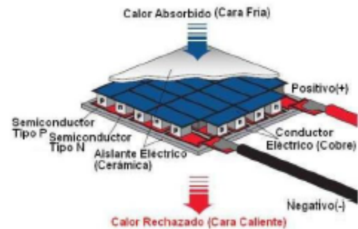
Fig 3. Diagrama de la estructura interna del efecto peltier.
