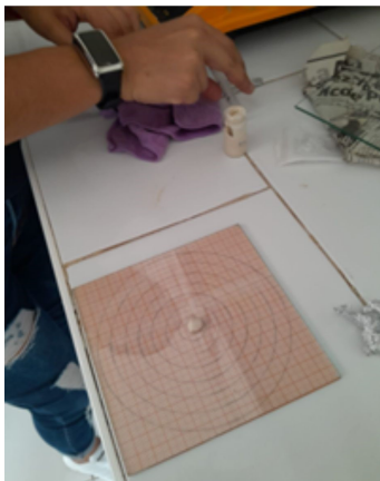
Figura 2.8: Medición de la consistencia de la pasta dental experimental utilizando una placa y cuadrícula para análisis.
