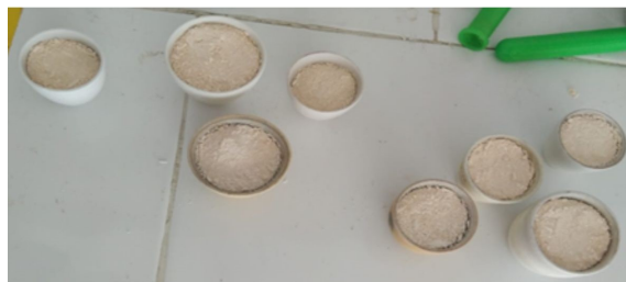
Figura 2.4: Muestra de hidroxiapatita obtenida después del proceso de calcinación.
