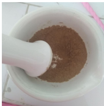
Figura 2.3: Muestra de hueso de pollo pulverizado después del proceso de tamizado.
