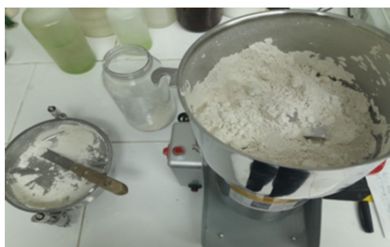
Figura 2.5: Segunda molienda de hidroxiapatita obtenida después del proceso de calcinación.
