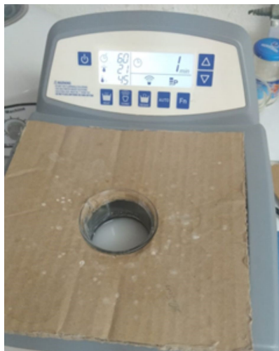
Figura 2.6: Proceso de sonicación de muestras de HAp ya tamizadas.
