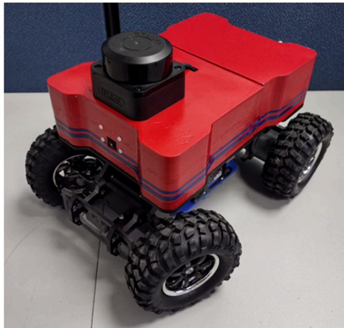
Figura 37: Vehículo autónomo no holomónico estilo Akermann. Fuente propia.
