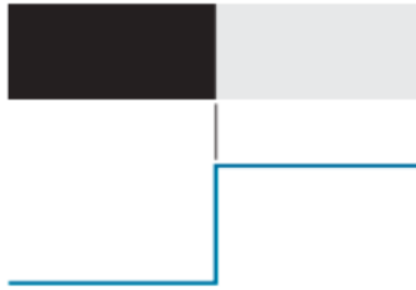
Figura 20: Representación del buscador de bordes de convolución, borde tipo STEP. Tomado de: ( https://blog.roboflow.com/edge-detection/ ).
