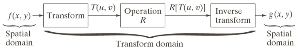
Figura 19: Transformación en el dominio de la frecuencia. Tomado de: ( https://asignatura.us.es/imagendigital/Tema3-Frecuencia.pdf ).
