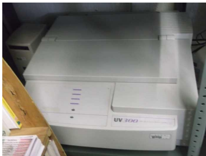
Figura 3-4: Espectrómetro de doble haz Spectronic UV-Vis Unicam 300 Espectrómetro UV-Vis usado para obtener la absorbancia y reflectancia de las películas delgadas con depósito de material híbrido dopado con R6G
