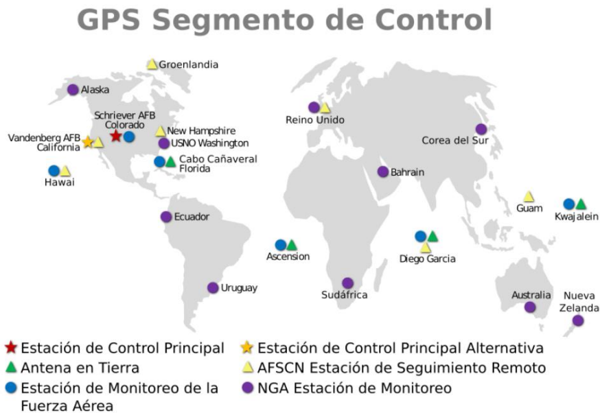
Imagen 8. Red global de estaciones en tierra de rastreo, monitoreo, análisis y control. Fuente: Liliana. a. (2019) La Matemática detrás del GPS. NGA: Agencia Nacional de Inteligencia Geoespacial. AFSCN: Fuerza área de Control de Satélites.
