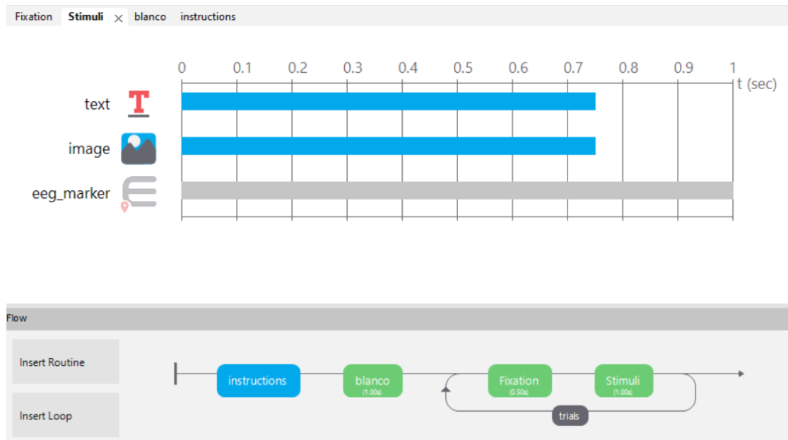
Figura 6.49. Diseño del experimento en la interfaz psychopy a través de bloques de programación y componentes de Emotiv.
