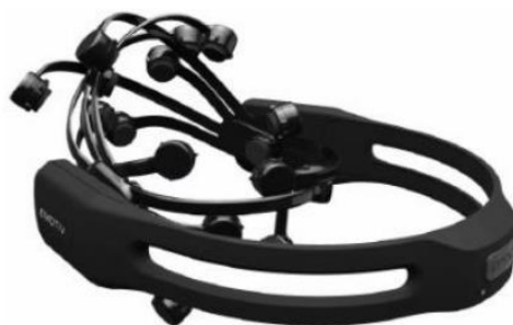
Figura 3.13. El casco Emotiv EPOC+ es un ejemplo de instrumento no invasivo para tomar datos (Emotiv, 2020).
