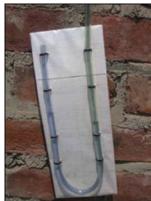
Imag.25 Izquierda. Manómetro casero. Retomado de Lacueva (2011). Imag.26. Derecha. Detalle de Manómetro. Guardado (2006).
