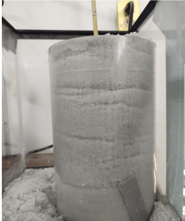
Figura 2.5: Preparación del sistema experimental para el caso húmedo o parcialmente saturado (Caso 2). Se llevaron a cabo cinco intrusiones y extracciones seguidas para una preparación.
