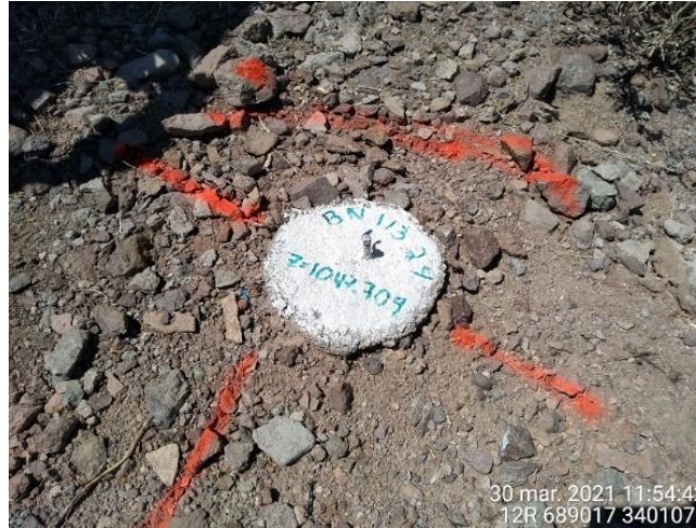
Imagen 73. Puntos de control (Mojoneras) entregados por la residencia SCT. Fuente: Propia.
