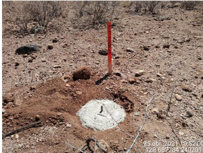
Imagen 82. Mojonera utilizada como referencia de punto geométricos en campo. Fuente: Propia.
