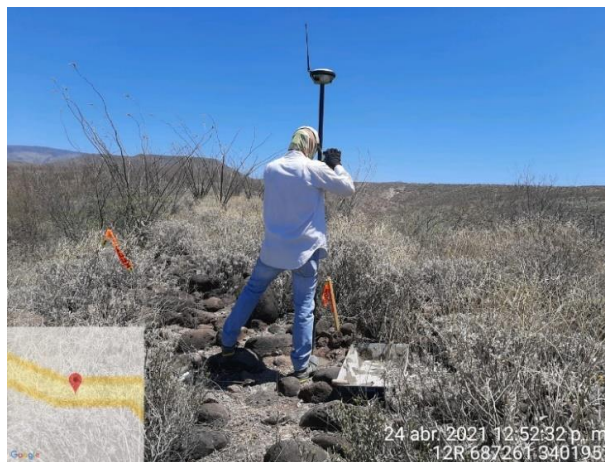
Imagen 27. Colocación de puntos de control con GPS RTK. Fuente: Propia.
