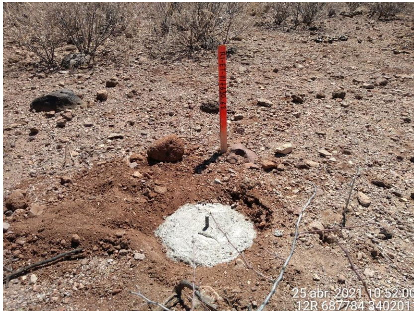
Imagen 52. Mojonera de una referencia de trazo en el estado de Sonora. Fuente: Propia.
