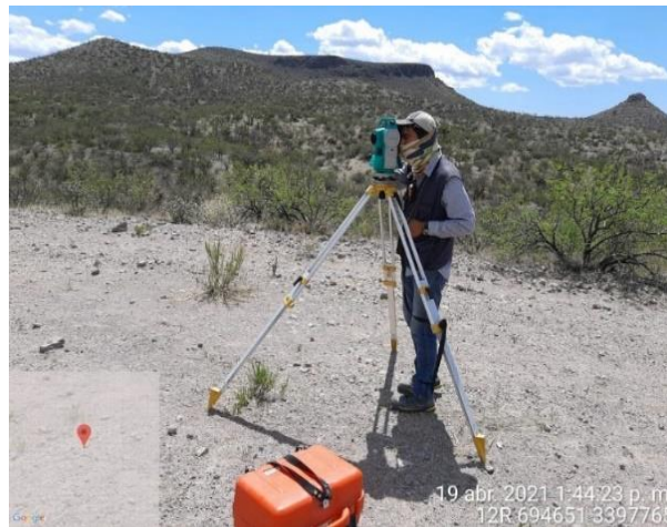
Imagen 76. Levantamiento topográfico con estación total Sokkia. Fuente: Propia.
