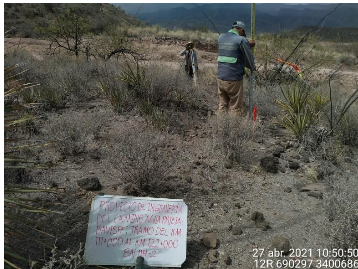
Imagen 81. Nivelación diferencial realizada en campo. Fuente: Propia.
