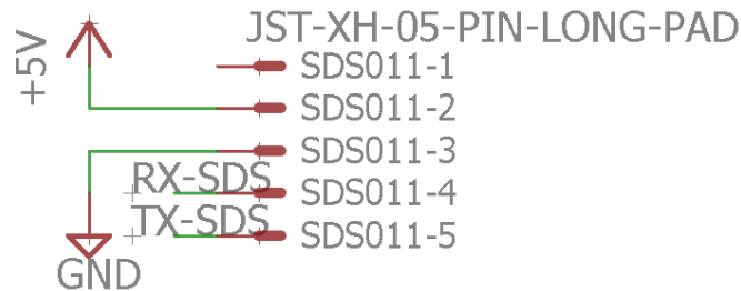
Figura 23. Esquema de conexiones del sensor SDS011.
