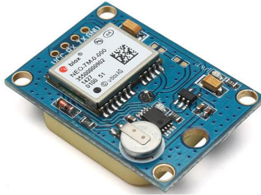
Figura 18. Módulo GNSS NEO-7M.
