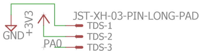
Figura 24. Diagrama de conexión del módulo TDS.
