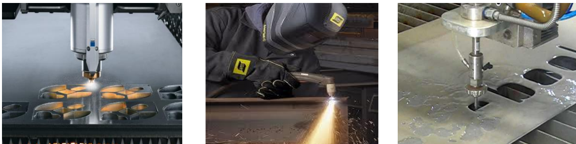
Figura 7, Tipos de Cortes de Lámina, a) Laser, b) Plasma, c) Chorro de Agua Fuente: (Google, s.f.).
