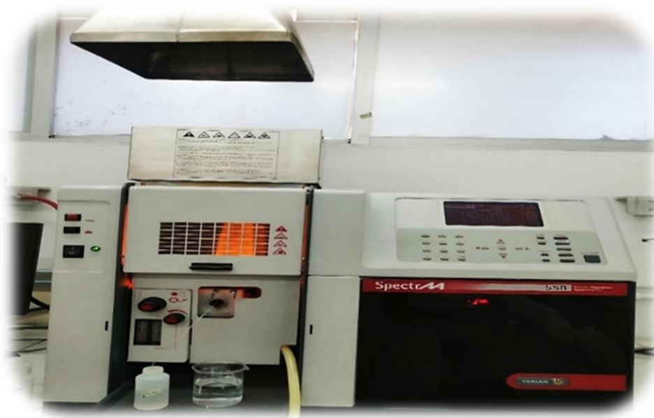
Figura 29. Espectrómetro de absorción atómica para la cuantificación de calcio, magnesio y micronutrientes en plántulas de chile serrano
