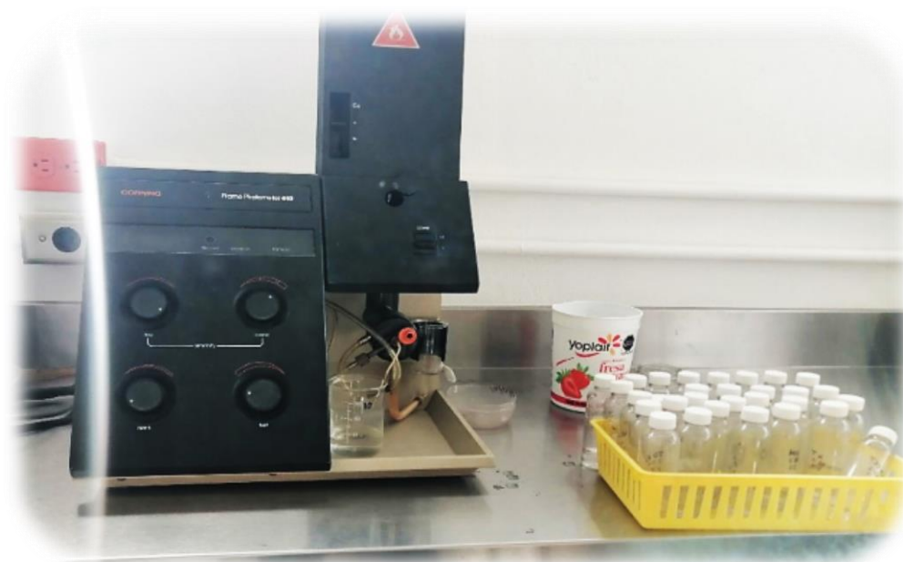
Figura 27. Flamómetro para la cuantificación de potasio en plántulas de chile serrano
