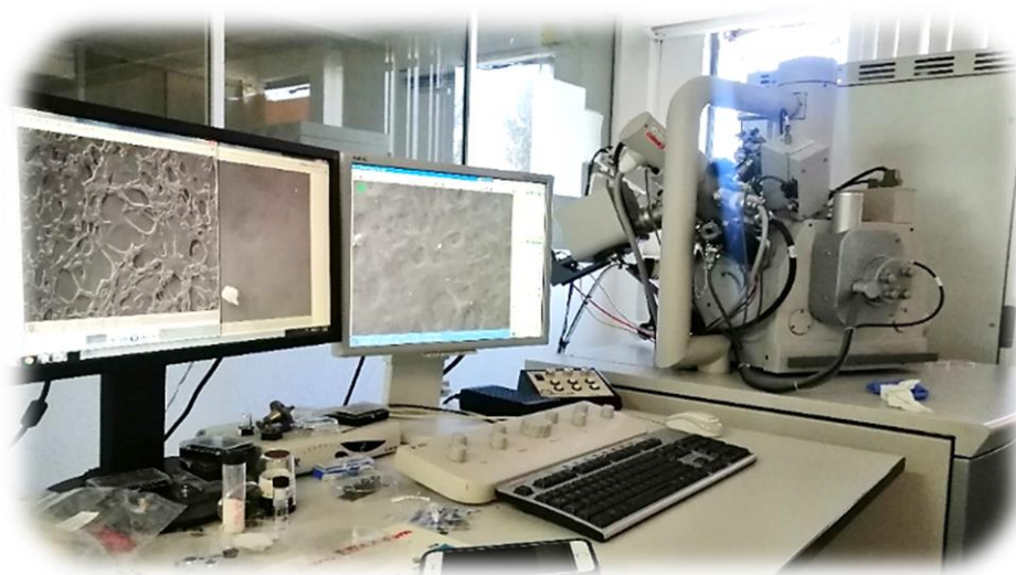
Figura 25. Microscopio Electrónico de Barrido utilizado para la obtención de micrografía y tamaño de poros del xerogel de HGS-1.25
