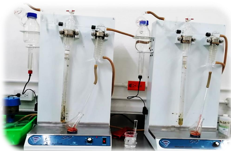
Figura 26. Micro destilador Kjeldahl para cuantificación de nitrógeno para su cuantificación en plántulas de chile serrano
