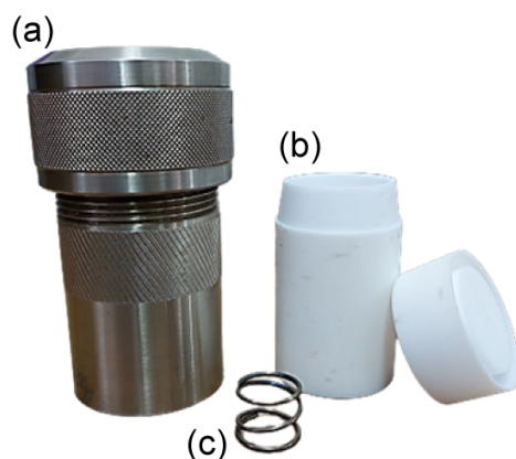
Figura 3.6: (a) Autoclave de acero inoxidable, (b) revestimiento de teflón y (c) resorte.
