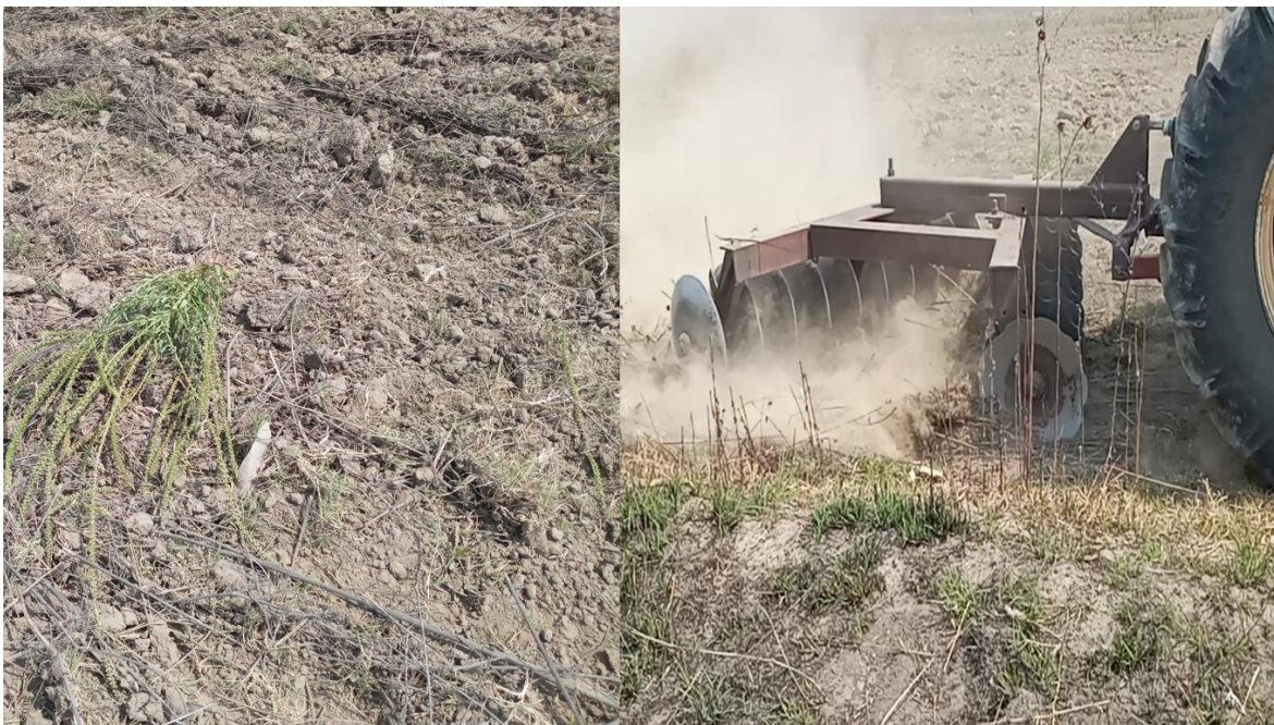
Figura 7. Rastra. Izquierda: suelo después de aplicar rastra; derecha tractor con rastra (Fotografía: elaboración propia, 2021).
