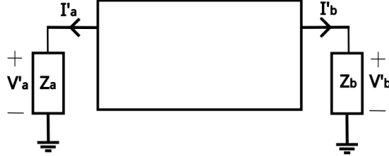
Figura 2.13: Efecto Miller. Imagen basada en [26] [27]
