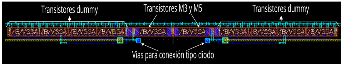
Figura 3.18: Transistores NMOS de segunda etapa conectado como diodo.
