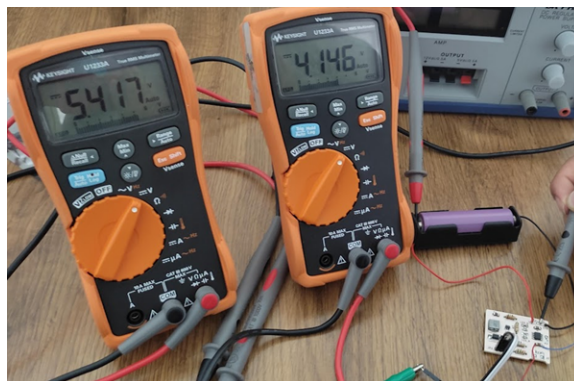
Figura 3.40. Mediciones del voltaje de batería y el voltaje de salida.
