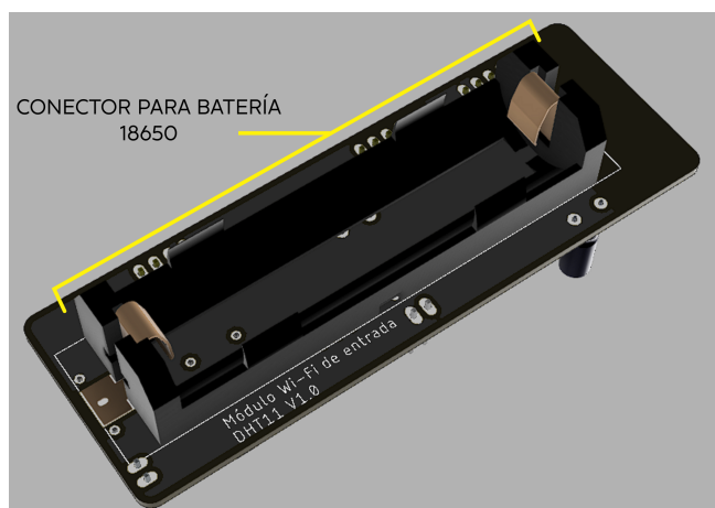
Figura 3.45. Montaje y distribución trasera del Módulo Wi-Fi de con sensor integrado DHT11 v1.0.
