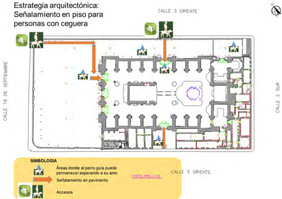
Ilustración 5.40 Señalamiento en pavimentos para ciegos
