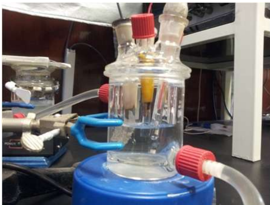
Figura 3.1 Sistema experimental de tres electrodos utilizado para el electrodeposición de películas delgadas de CdS.
