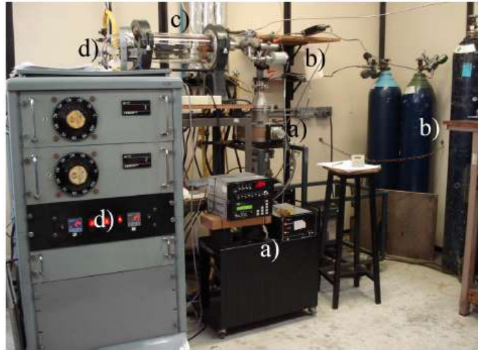
Figura 2.7 Sistema de crecimiento CSVT y sus cuatro componentes principales. a) Sistema de vacío, b) Control de Flujo de Gases, c) Cámara de crecimiento y d) Sistema de control de temperatura, figura tomada de [27].
