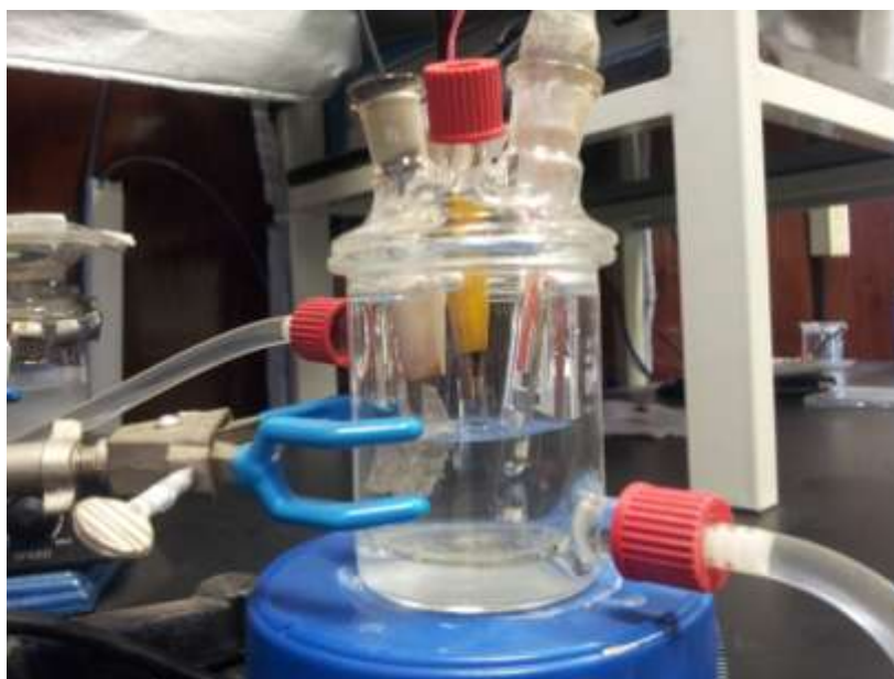
Figura 4.2 Arreglo de la configuración geométrica de los electrodos para el proceso de electrodeposición.
