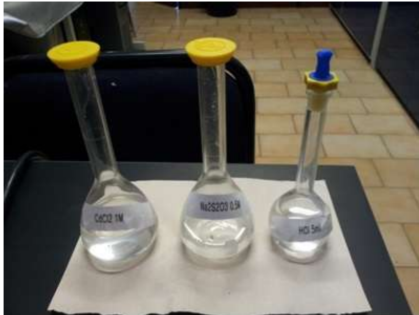
Figura3.3. Soluciones base utilizadas para la preparación del baño de \text{CdCl}_2 1.0 M y \text{Na}_2\text{S}_2\text{O}_3 0.5 M, se agregó HCl para control de pH.
