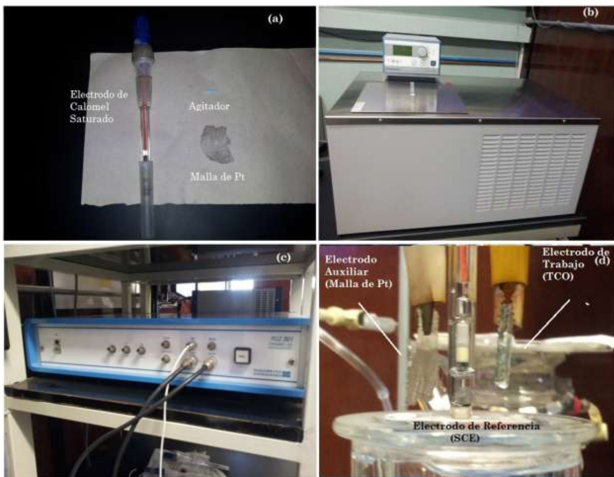
Figura 3.2. (a) Imagen de los electrodos y agitador magnético, (b) re-circulador con control de temperatura, (c) potenciostato equipo Voltalab PGZ301, y (d) celda electroquímica con tres electrodos.
